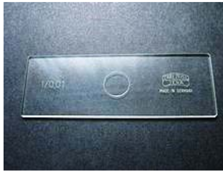
Rys. 1. Szkiełko kalibracyjne zwane szkiełkiem mikrometrycznym lub mikrometrem obiektywowym
