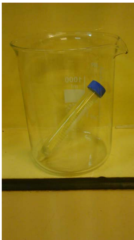
Rys. 1. Zlewka z umieszczonym wewnątrz pojemnikiem z kulką (do mierzenia lepkości).
